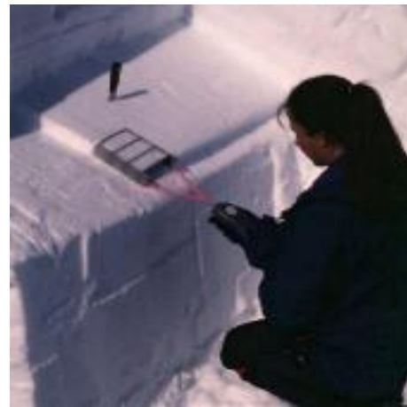
(d) Shear frame test
